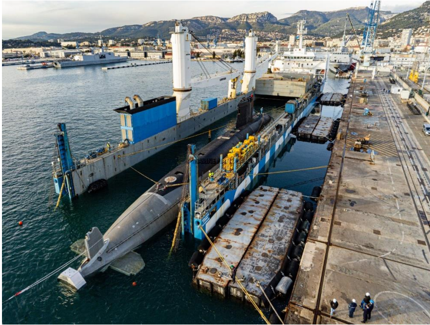
Figure 1- Transfert du sous-marin nucléaire d'attaque (SNA) Perle le lundi 7 décembre 2020, depuis son quai d'amarrage vers son emplacement à bord du RollDock Storm
